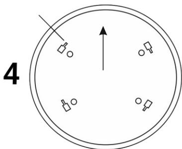
Отклейте вторую защитную пленку. Совместите отверстия в креплении с просверленными отверстиями в стене. Приклейте крепление к стене. Зафиксируйте крепление на 4 самореза.
