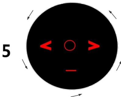
Совместите отверстия в динамике с пазами на креплении. Плотно прижмите динамик к креплению и поверните его против часовой стрелки.
